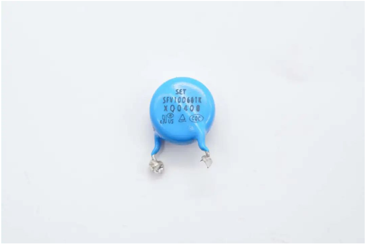
压敏电阻外套热缩管，来自SET赛尔特，型号SFV10D681K，用于浪涌保护。
