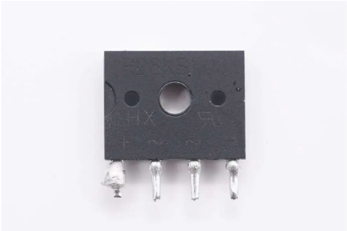
整流桥丝印RD8KB100，规格为8A 1000V。
