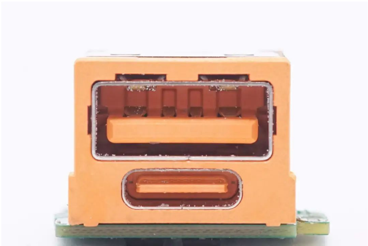
USB-A母座特写，正负极加宽，支持大电流快充。
