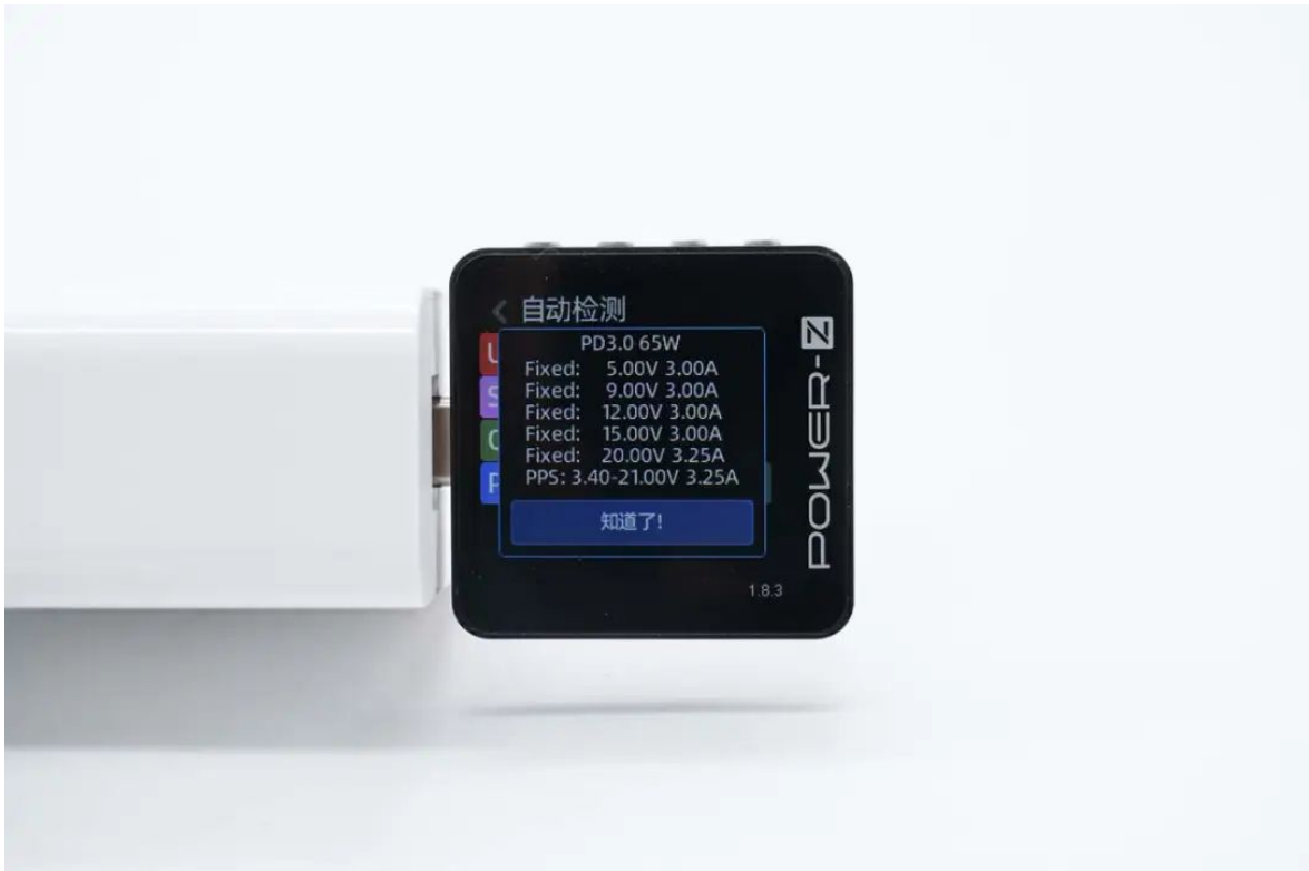
PDO报文显示USB-C口具备5V3A、9V3A、12V3A、15V3A、20V3.25A五组固定电压档位，以及3.4-21V3.25A一组PPS电压档位。
