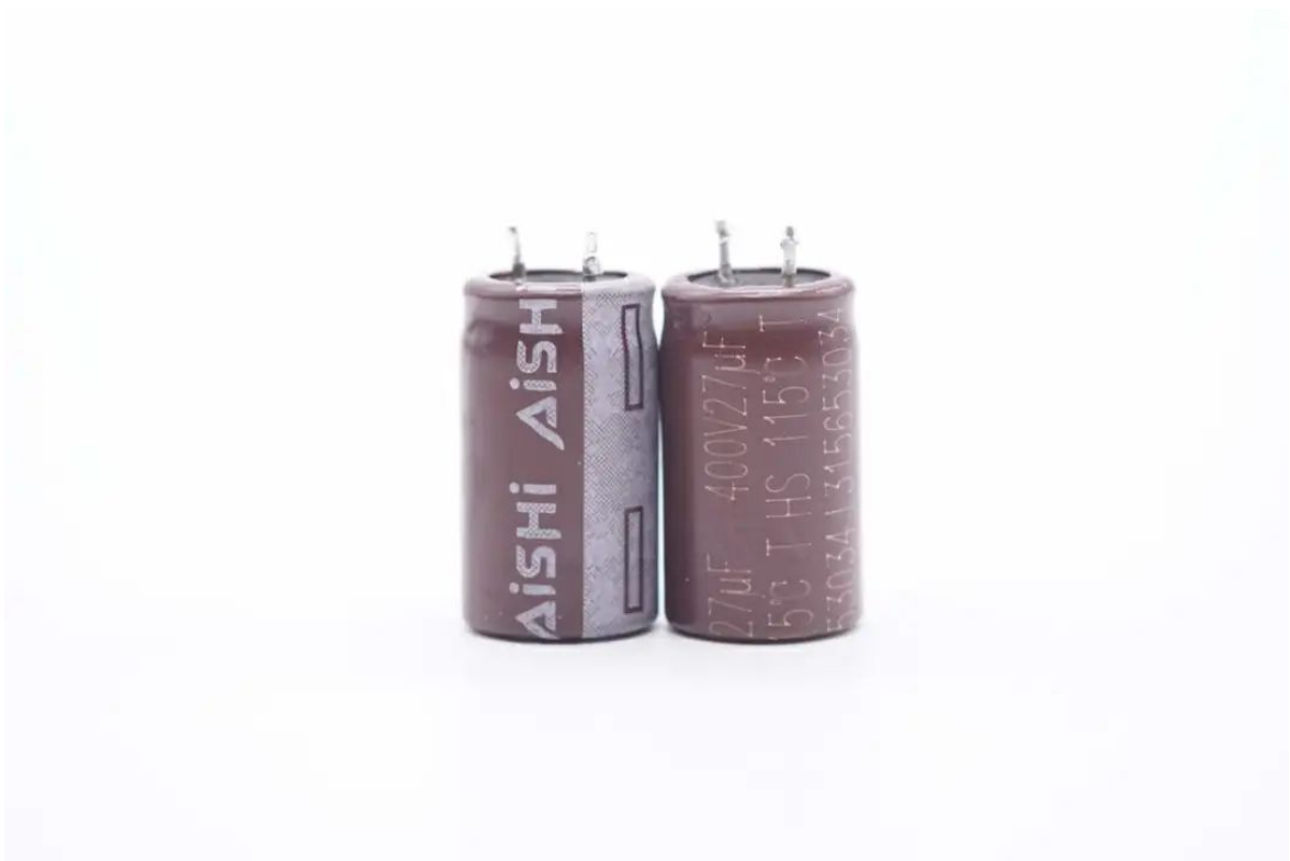
两颗高压滤波电容来自艾华，规格为400V 27μF。
