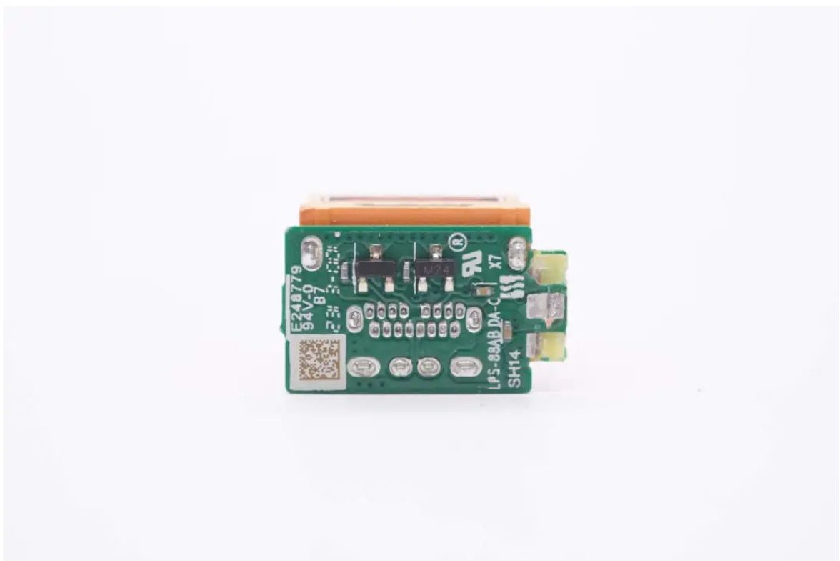
融合接口小板背面焊接两颗TVS管。
