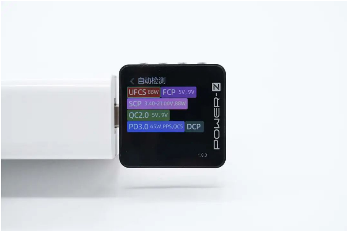
使用ChargerLAB POWER-Z KM003C测得充电器USB-C口支持UFCS（88W）、FCP、SCP、QC2.0/5、PD3.0、PPS、DCP充电协议。
