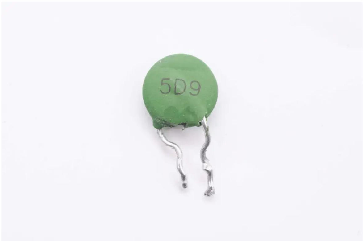
5D9 NTC热敏电阻外套热缩管，用于抑制插电时的浪涌电流。
